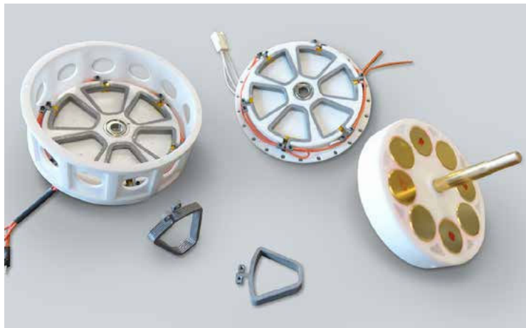
Le moteur axial en cours d'assemblage final avec ses deux stators et son rotor. (Crédit photo : Dominique Harribey)
